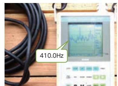
⑥周波数を計測・記録し、記録データをコンピューター解析して、木材のヤング率、強度を設定する
