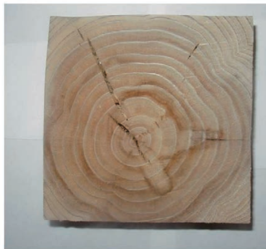
高温低湿乾燥では表面割れ が発生しない
