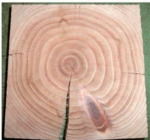
天然乾燥や一般的の中温乾燥 では表面割れが発生
